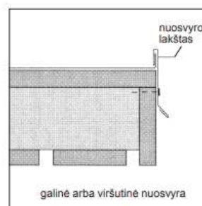
Nuosvyros lakštas tvirtinamas vinimis ne didesniu kaip 800 mm žingsniu.
